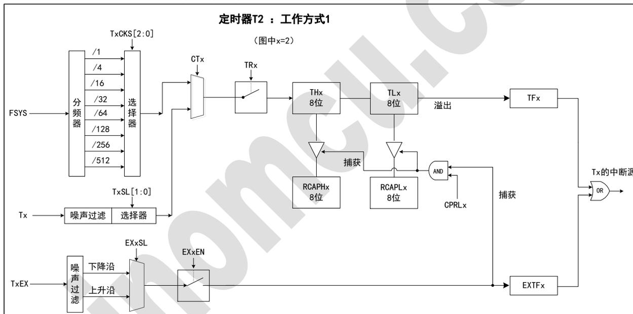
输入捕获功能，主要用于测量脉冲宽度或周期。在 T2 的捕获方式中，时钟源由 CT2 位决定是对 F<sub>sys</sub> 或其分频计数，还是对 T2 端口输入信号计数。T2 的 T2EX 端口的输入由 EX2EN 位控制，当在该方式下打开了 T2EX 端口后，芯片始终通过监视并捕获 T2EX 端口上的有效信号。RCAPH2 和 RCAPL2 保存最近一次捕获的结果。一旦产生了输入捕获事件，硬件自动把 TH2 和 TL2 中的当前值分别送到 RCAPH2 和 RCAPL2 中保存。输入捕获事件指，T2EX 上产生一个有效的输入捕获信号有效，并被芯片识别（T2 硬件对 EXTF2 标志位置 1）的过程。注意若捕获事件发生前的时间间隔超过最大计数，同样会产生 T2 定时器的溢出（TF2 标志位置 1）引起 T2 中断，但用户可以通过标志位的不同进行区分。另外，当 RCAPH2 和 RCAPL2 中保存了 TH2 和 TL2 的溢出值（0x0），也是一种异常情况，用户应该做特别处理。
