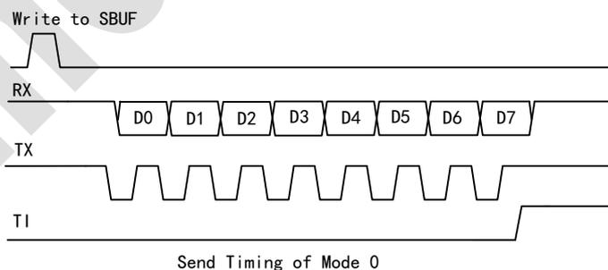
UART 模块通过 TX 引脚输出同步时钟，通过 RX 引脚将数据读入或移出串行端口。任何将 SBUF 作为目标寄存器的写操作都会启动发送。下一个系统时钟 TX 控制块开始发送。数据转换发生在移位时钟的上升沿，移位寄存器的内容逐次从左往右移位，空位置 0。当移位寄存器中的所有 8 位都发送后，TX 控制模块停止发送操作，然后在下一个系统时钟的上升沿将 TI 置 1。
