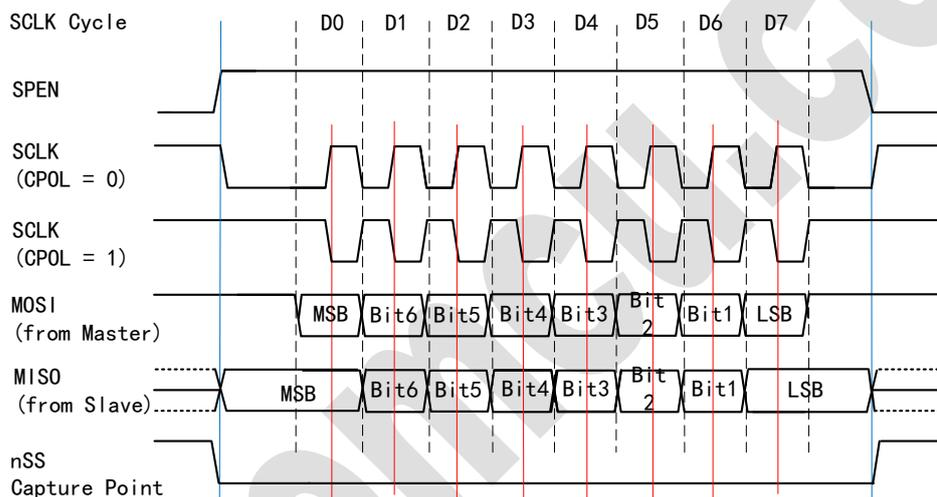
当 CPHA=1，主设备在 SCLK 的第一个沿将数据输出到 MOSI 上，从设备把 SCLK 的第一个沿作为开始发送信号，SCLK 的第二个沿开始捕获数据，因此用户必须在第一个 SCLK 的两个沿内完成写 SPDAT 的操作。这种数据传输格式是一个主设备一个从设备之间通讯的首选。
