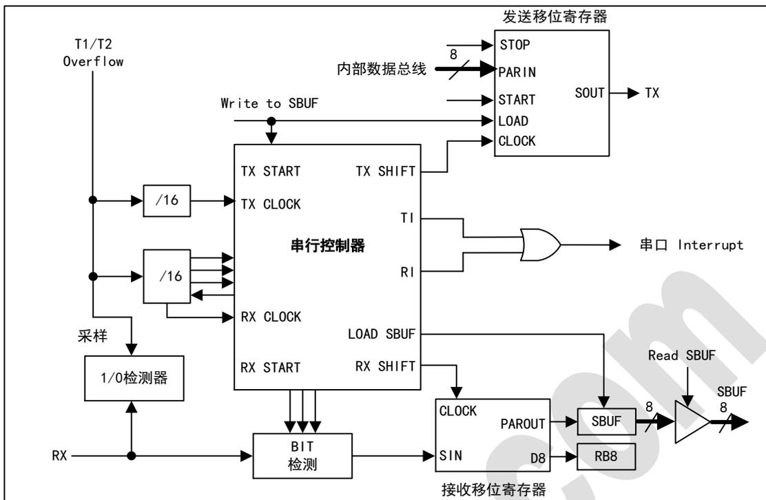
任何将 SBUF 作为目标寄存器的写操作都会启动发送,实际上发送是从 16 分频计数器中的下一次跳变之后的系统时钟开始的,因此位时间与 16 分频计数器是同步的,与对 SBUF 的写操作不同步。起始位首先在 TX 引脚上移出,然后是 8 位数据位。在发送移位寄存器中的所有 8 位数据都发送完后,停止位在 TX 引脚上移出,在停止位发出的同时 TI 标志置 1。
